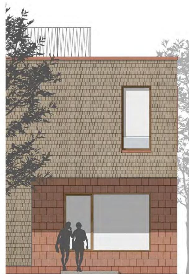
Gestalträgend ist die Schindelstruktur der Außenhülle. Der überwiegenden Teil bekleidet kleinere Lärchenschindeln, während der zurückspringende Eingang mit Kupferschindeln versehen ist – eine Kombination aus nachwachsenden Rohstoffen und sparsam eingesetztem, wertvollem Material als urbane Mine.
